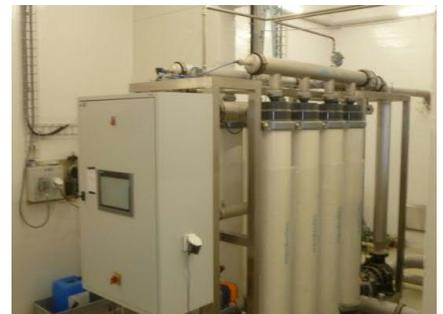
Auf dem Chassis der Anlage befinden sich der Vorfilter, die Einlaufpumpe, die Membranen, die Umwälz- und Rückspülpumpe sowie sämtliche Mess- und Regeltechnik inkl. Schaltschrank.
