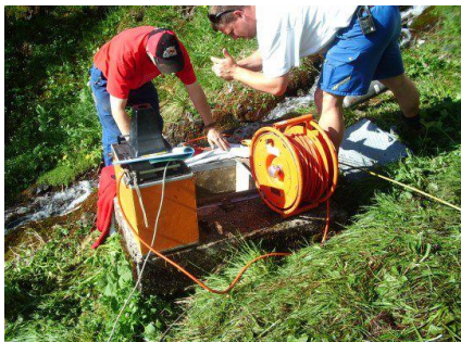
Untersuchung der Quellfassungen mittels Kamera
