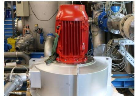
Turbine auf Prüfstand bei Trockenabnahme
