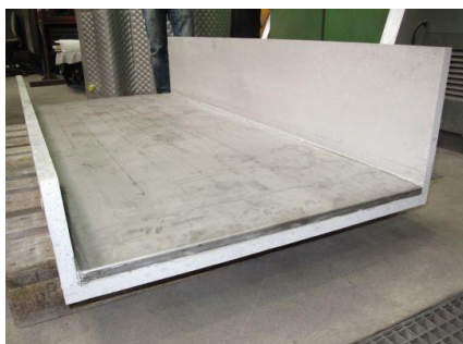
Der vorfabrizierte Polymerbetonwärmetauscher (Anschluss Vor- & Rücklauf seitlich)
