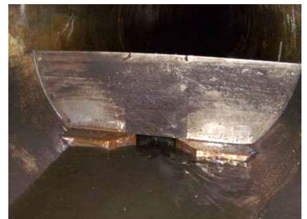
Speicherversuch in der Sticheitung Halenstrasse DN 1250 mm mittels temporärer Drosselung
