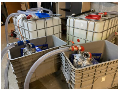
Komponenten für die Rohrbefüllung zwingend getrennt anwenden – kommen diese miteinander in Berührung, bildet sich ein sandsteinartiges Konglomerat.
