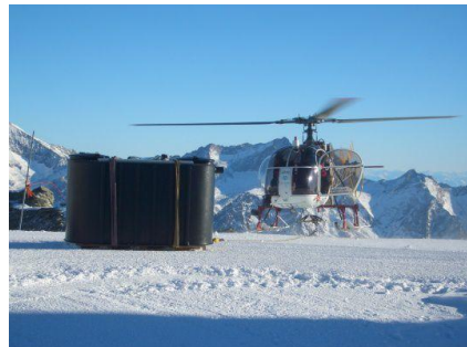
Fettabscheider Lieferung per Helikopter (Mittelallalin auf 3'500 m ü. M.)
