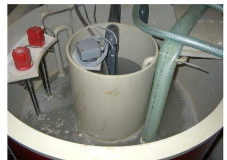
Versuchsanlage Ultrafiltration: Arbeits- und Spülbehälter
