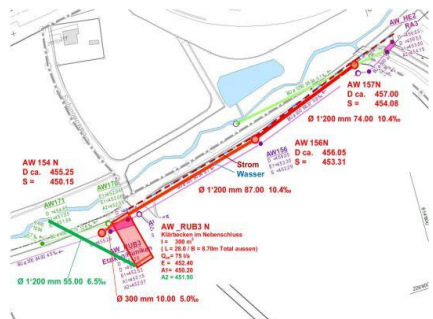
GEP-Massnahmeplan: Beispiel einer etappierten Massnahme
